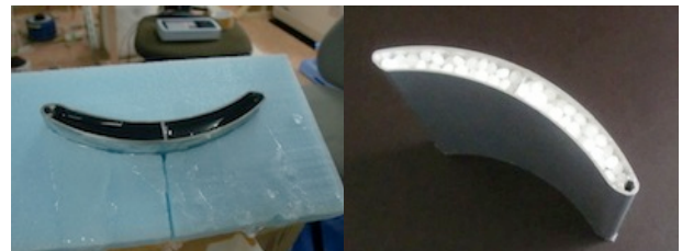
写真 2 ゲル状 PCM の充填 写真 3 粒状 PCM の充填
