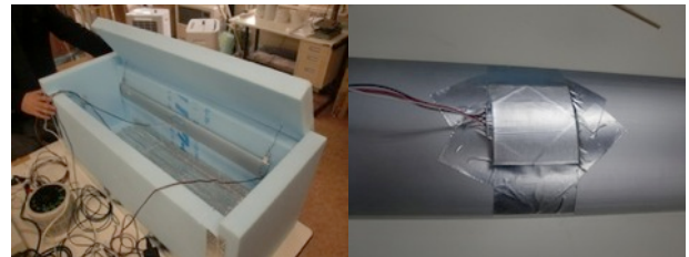
写真 4 加熱チャンバー 写真 5 熱流計の添付
